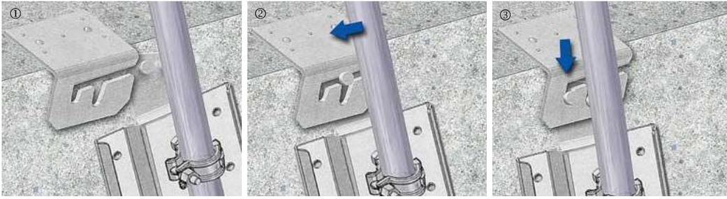
*Montage in drei Schritten: Pfosten nebst Pfostenhalter von der Gebäudekante (unter Einbeziehung von PSA-Schuttmittel) an die Ankerplatten-Arretierung heranführen. In einem leichten Winkel Pfosten und Postenhalter in die Ankerplatten-Arretierung bewegen. Abschließend Pfosten und Postenhalter in die Endposition der Arretierung absinken lassen.*
