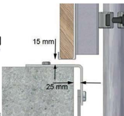
Bild 4: Abstand zum Bauwerk Standard
