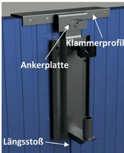
Bild 10: Schematische Darstellung des kurzen Klammerprofil über Längsstoß
