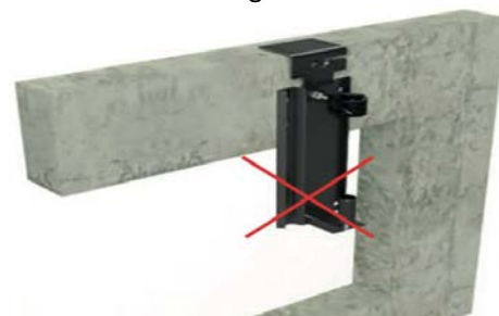
Bild 18: Unteres Ende ohne ausreichendes Widerlager
