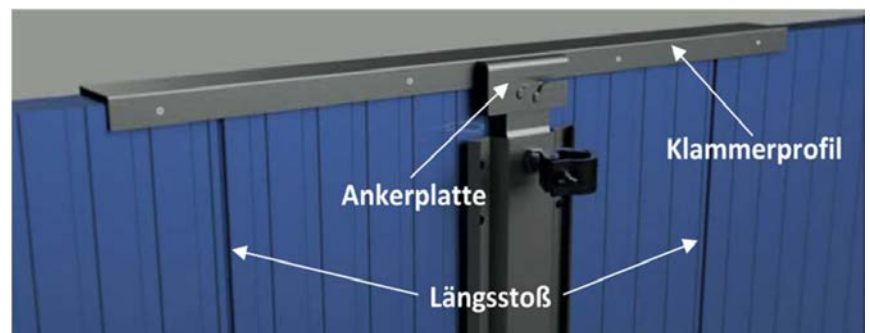
Bild 11: Schematische Darstellung des langen Klammerprofil über Längsstößen
